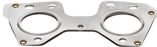
Zu einem einlagigen Metallgichtsystem mit patentierter Halbsicke unter Verwendung von Metalseal™ L der ElringKlinger als Ausgangsmaterial. Hinzu kommt auf dem Auspuffkrümmer zu gewandten Seite ein Gleitlack auf Basis von Molybdän Disulfid/Graphit. Zusätzlich wird ein Bindemittel aus hochtemperaturbeständigem Harz hinzugefügt, welches vor allem der Reibverschleißreduzierung dient.
