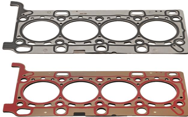
En outre, le mode d'assemblage des couches métalliques a été modifié. Le joint référence 598.670, qui n'est plus produit, était assemblé au moyen de quatre points de soudure. Dans le cas de son successeur, le joint référence 867.700, les couches métalliques sont désormais fixées les unes aux autres au moyen de rivets. Ceci n'implique pas de changement en ce qui concerne le montage du joint de culasse.
