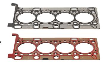
Además se ha cambiado la conexión de las capas metálicas individuales. La junta que ya no se producía con el número de artículo 598.670 estaba conectada con cuatro puntos de soldadura. Las capas metálicas se conectan firmemente ahora a través de remaches en la siguiente junta con el número de artículo 867.700. En principio, esto no cambia durante la instalación de la junta de culata.
