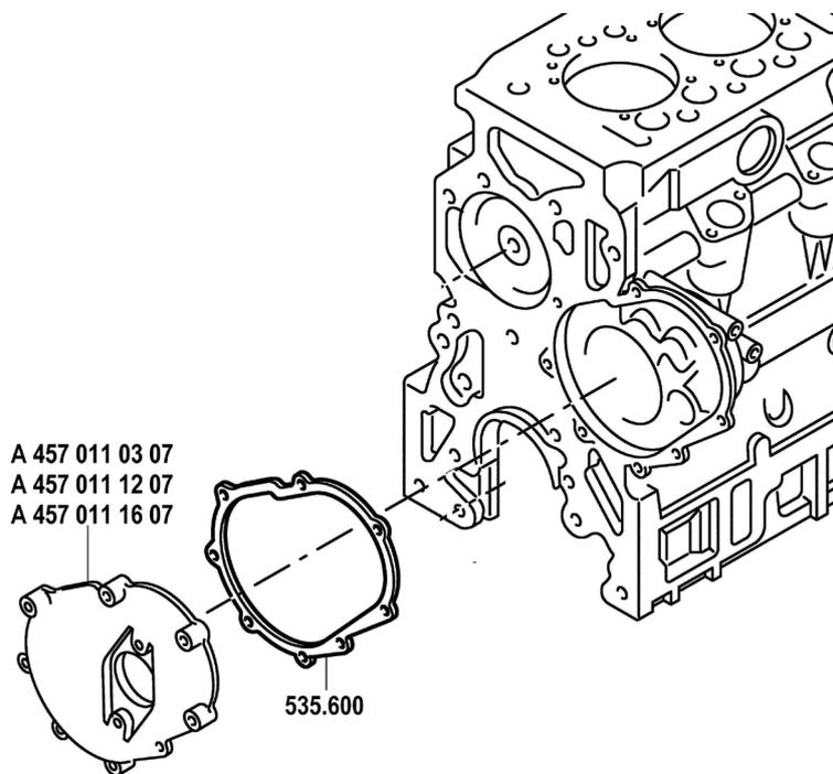
Для лучшего уплотнения крышки приводной шестерни распределительного вала в блоке цилиндров разработана новая уплотнительная прокладка Metaloseal®. Она заменила использовавшийся до настоящего времени на этом месте герметик.
