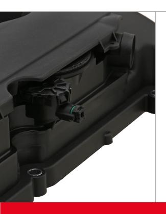
En los modelos de vehículos diseñados especialmente para el mercado coreano o americano, en lugar del tapón de cierre rojo debe montarse el tapón de válvula abierto. Se puede ver en la imagen de la izquierda.
