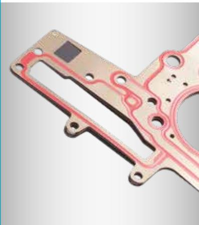
A Metaloflex™ da ElringKlinger é uma marca registrada reconhecida mundialmente para as inovadoras juntas do cabeçote de camadas metálicas de rolamentos de aço para molas com nervuras e revestimento de elastômero para motores diesel e motores a gasolina de alta potência com injeção direta.
