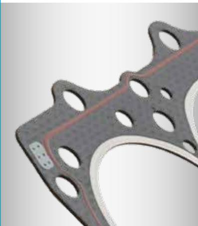
Juntas do cabeçote de metal e material macio da ElringKlinger feitas de uma placa de suporte dentada com suporte de material macio laminado dos dois lados para o reparo e a manutenção de motores usados.
