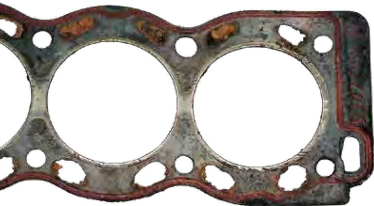
Eine Zylinderkopfdichtung, die durch Überhitzung ausgefallen ist, kann man beispielsweise sehr gut an den Aufwürfen des Weichstoffs in unmittelbarer Nähe der Wasserdurchgänge deutlich erkennen.
