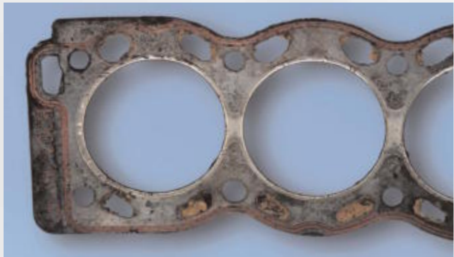
Joint de culasse endommagé
